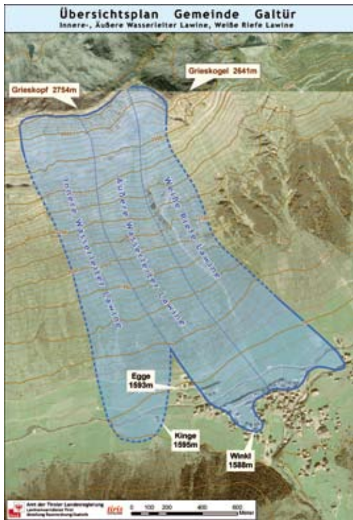
Abb. 26: Übersichtsplan Galtür (Orthofoto) mit Sonnberg und den Lawinenumrissen; feste Linie: erhobene Lawinenumrisse, unterbrochene Linie: vermutliche Umrisse (Quelle: Mair, 2008)
