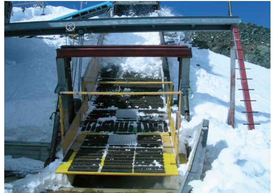
Abb. 2: Nassschneelawine vom 15. April 2005 auf der Gleitbahn auf dem Weissfluhjoch/Davos. Mit 2 Kraftmessplatten wurden die Normal- und Reibungskräfte nach einer Umlenkung von 8° gemessen.
