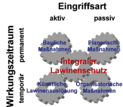
Abb. 42: Integraler Lawinenschutz mit Differenzierung der Schutzmaßnahmen nach Eingriffsart und Wirkungszeitraum (Quelle: Mair, 2008)
