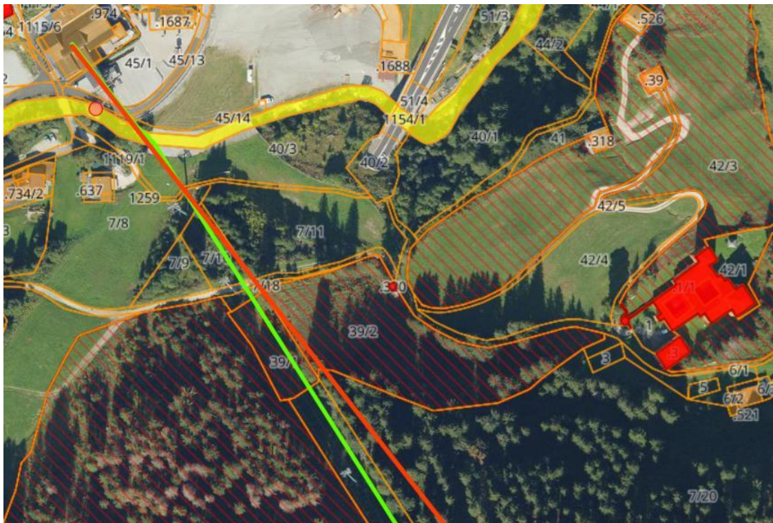
Figura 77: In rosso viene evidenziata la traccia del nuovo impianto di cabinovia, mentre in verde l'attuale tracciato. Le p.f. interessate dall'intervento sono la 39/1 e 39/2, indicate in arancio, le quali rappresentano le zone di rispetto di monumenti, derivanti
