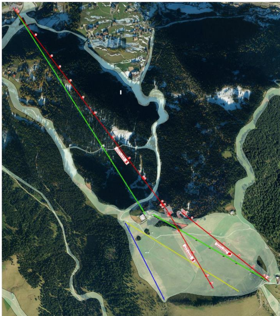
Figura 31: Ortofoto - Inquadramento generale degli interventi previsti. In verde si evidenziano gli impianti attuali oggetto di intervento, in rosso lo stato di progetto come previsto a conclusione delle opere.
