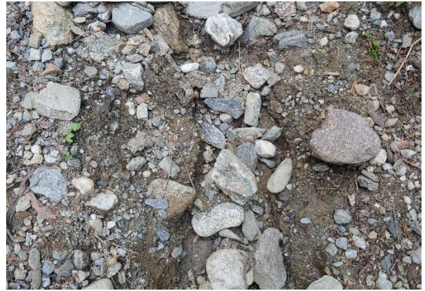
Foto 6: Fluvioglaziale Sedimente im Bereich der geplanten Piste, knapp nördlich der Einmündung in die Herneggpiste.
