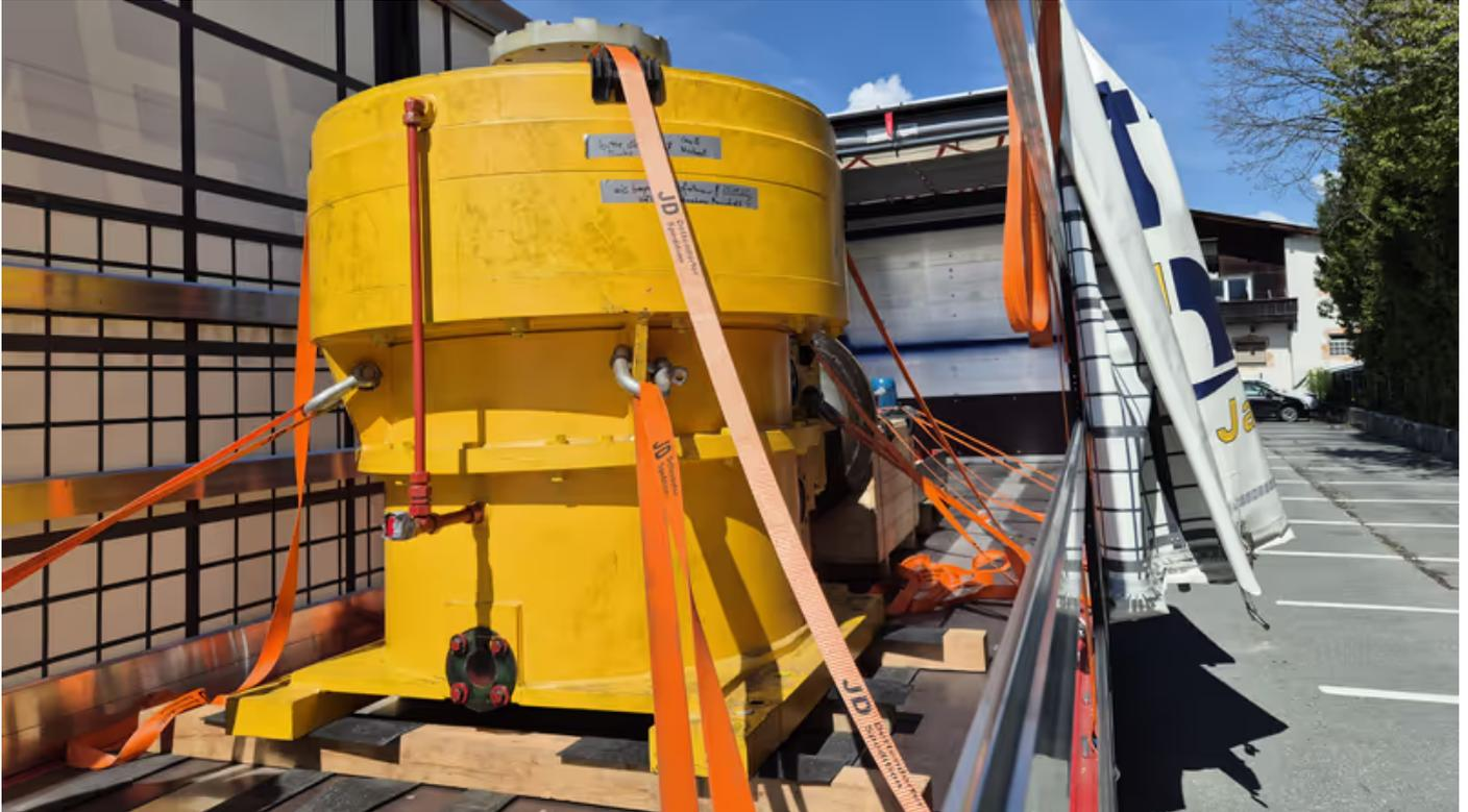
Das Herzstück, das Getriebe, musste zur Wartung ausgebaut und vom Hahnenkamm nach Wien und zurück gebracht werden.
