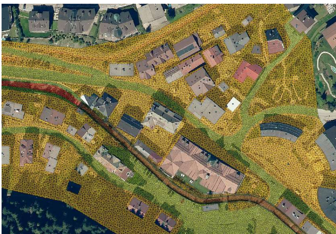
figura 19: Estratto del dominio computazionale per il modello Basement in corrispondenza della confluenza con il rio di Vallelunga – torrente I.200. Mesh triangolare irregolare.
