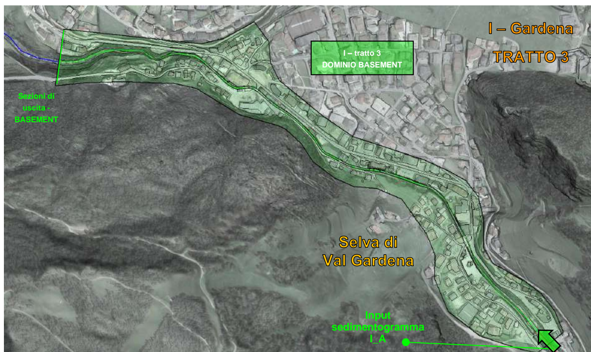
figura 17: Dominio computazionale del tratto 3 del rio Gardena. Dominio di calcolo BASEMENT (spezzata in nero e retino verde).
