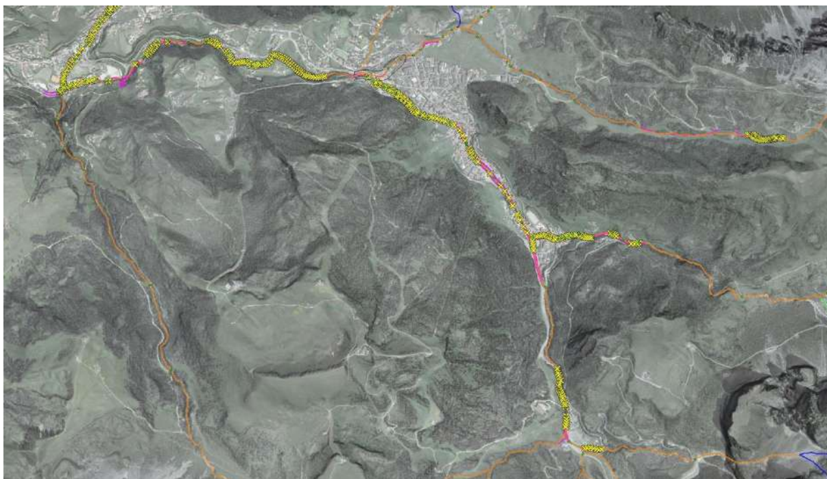
figura 11: Quadro generale delle opere di sistemazione idraulica presenti sul rio Gardena - I. Le opere sono state estratte dal catasto delle opere di difesa BAUKAT30 e raffigurate su ortofoto 2011. In giallo le opere trasversali, in verde i ponti ed in viola le opere longitudinali.
