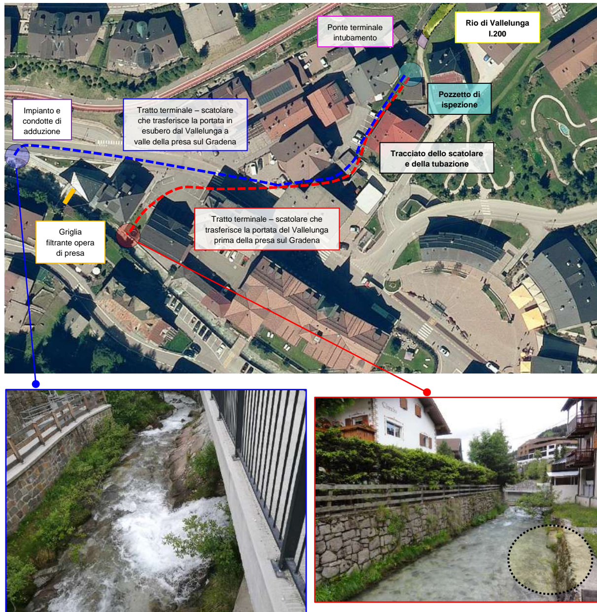
figura 21: Schema dell'opera di presa dell'Alperia sul rio Gardena - I, ed interazione con la portata derivante dal rio di Vallelunga – I.200.
